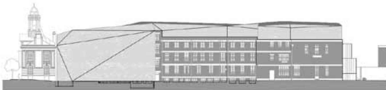
Prospetto Sud con la nuova parte e il piano supplementare rivestiti con la lamina metallica
